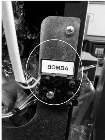
Fig. 9 – Ficha para conectar la bomba circuladora
