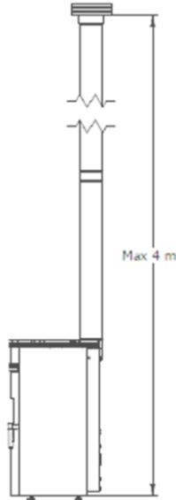
**Figura 27 - Exemplo de uma instalação tipo A**
