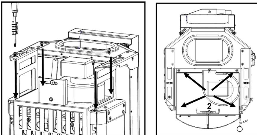
**Figura 112 – Fixação do ventilador ao equipamento**
