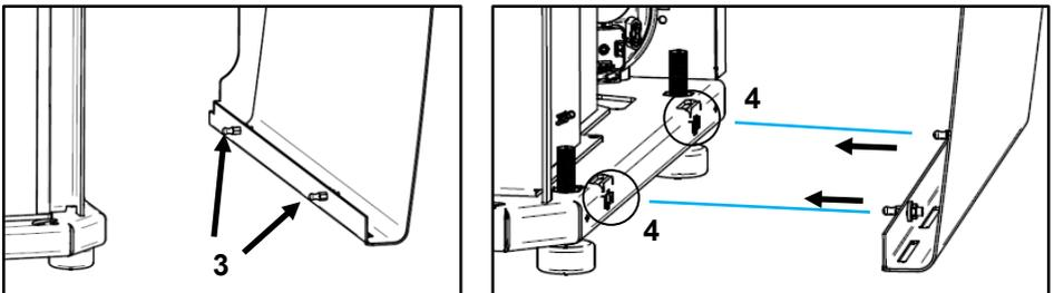
Figura 41 – Fixação das envolventes Pine e Leaf
