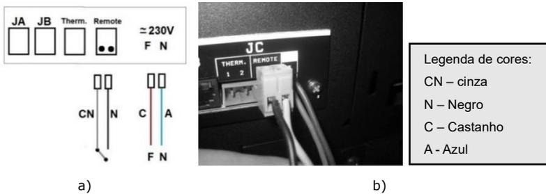
**Figura 148 – Ligação do comando remoto sem fios**
