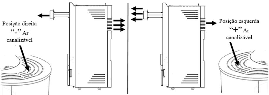
**Figura 123 – Regulação do registo do Ar canalizável “+” ou “-”**
