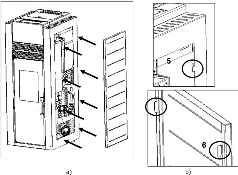
**Figura 68 - Colocação das capas laterais de acabamento**
