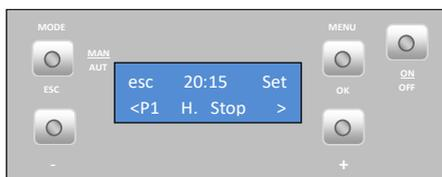
Para seleccionar a **temperatura de set point** no programa P1, carregar em "set" e começa a piscar, carregar na tecla "+" ou "-" para seleccionar a temperatura pretendida, carregar em "ok" para confirmar valor. Carregar na tecla "+" para passar para o menu "P1 Temp. Ar".
