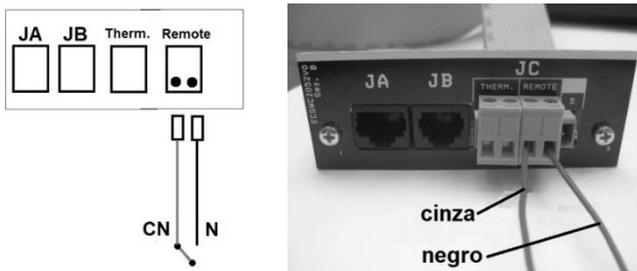
**Figura 149 – Ligações do comando externo com fios**
