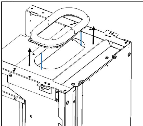
**Figura 52 - Remoção da borracha de vedação no equipamento**
