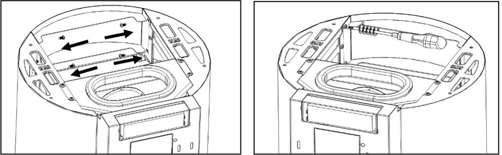
**Figura 81 - Fixação da capa ao frontal de acabamento**
