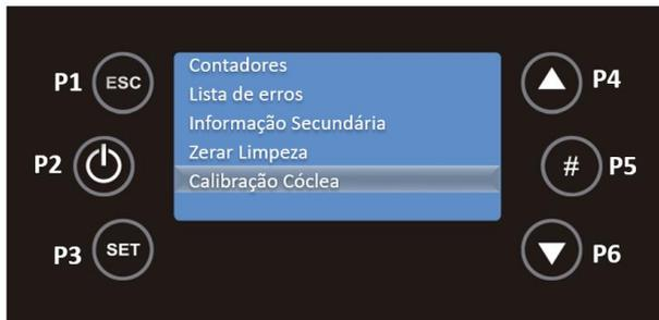
Neste submenu com as teclas P4 e P6 pode ajustar a quantidade de *pellets* a alimentar, entre -7 (-14%) e 7 (+14%). Para voltar ao menu Service pressione P1.
