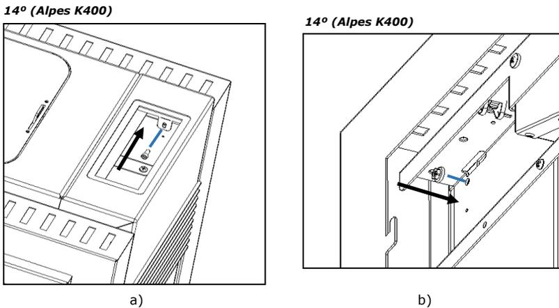
**Figura 67 A e B - Fixação das laterais estruturais**
