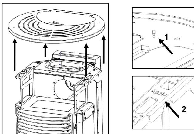
**Figura 74 - Remoção do tampo da K500**
