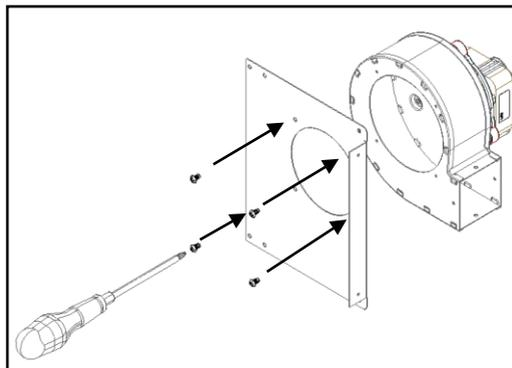
**Figura 126 - Fixação apoio com o ventilador**
