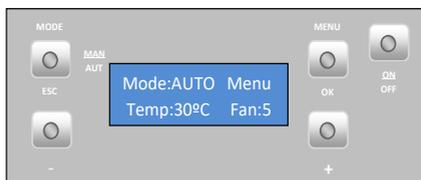
**Modo "auto":** neste modo a máquina vai ligar na potência máxima e permanecer nela até atingir uma temperatura 1°C acima da temperatura selecionada (temperatura de set point). Quando atinge essa temperatura passa a funcionar na potência mínima.
