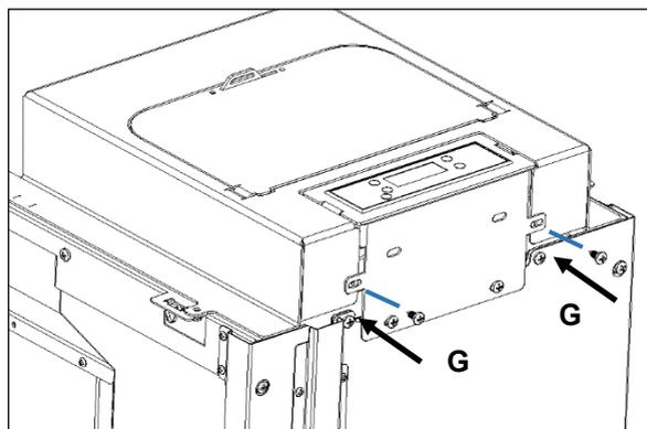
**Figura 57 - Colocação do tampo na estrutura do equipamento**
