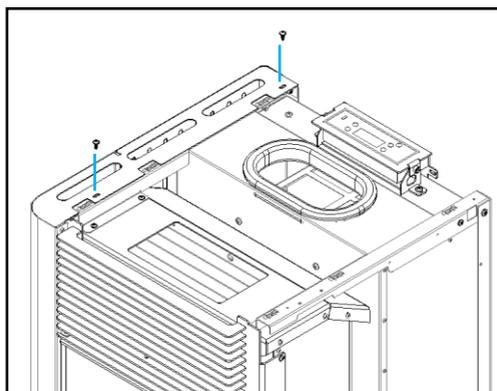
**Figura 98 – Fixação das capas laterais na parte superior**
