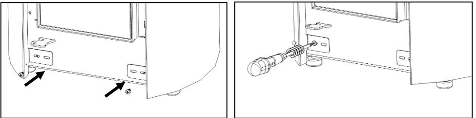
**Figura 82 - Fixação da capa ao frontal do equipamento**
