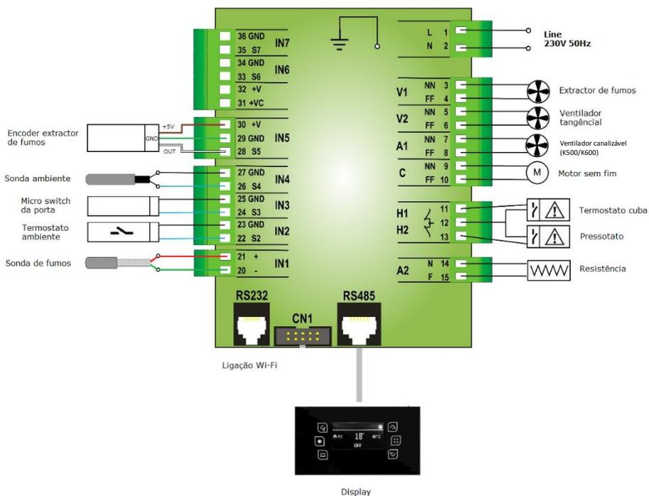
**Figura 154 – Esquema elétrico salamandras (eletrônica Columbus)**
