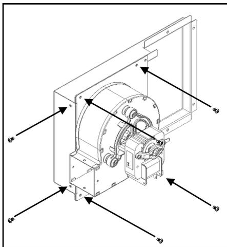
**Figura 127 - Fixação apoio com o ventilador**
