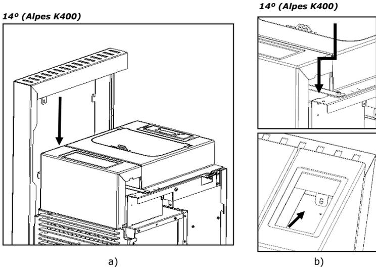
**Figura 66 - Encaixe das patilhas nas estruturas laterais**
