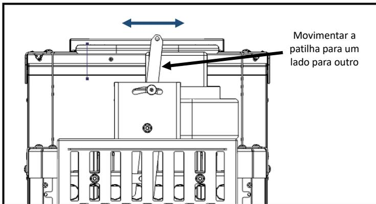
**Figura 119 – Verificar o bloqueio do registo**
