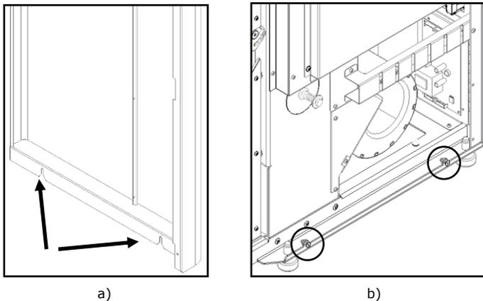
**Figura 96 – Encaixe lateral inferior das envolventes**
