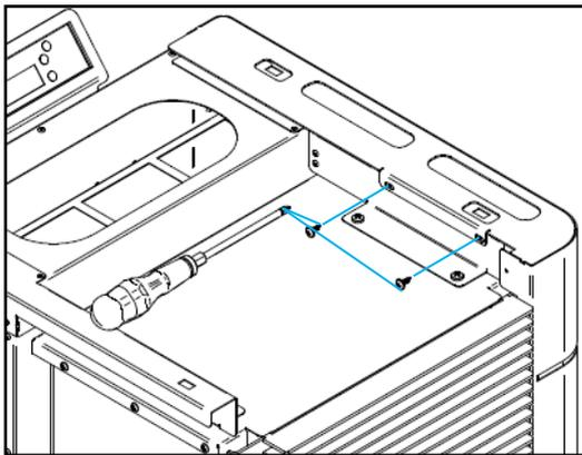
**Figura 24 - Fixação das envolventes laterais na parte superior**
