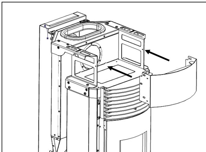
**Figura 75 - Encaixe do frontal da estrutura**
