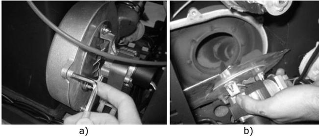
Figura 145 – a) Retirar os parafusos; b) Retirar extrator
