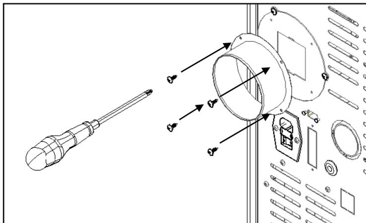
**Figura 132 - Fixação boca saída de ar na salamandra**
