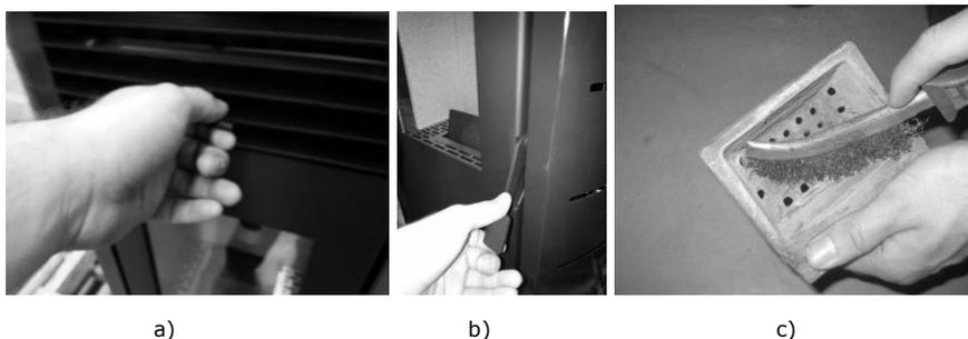
**Figura 138 – Barra de limpeza e fecho da porta**
