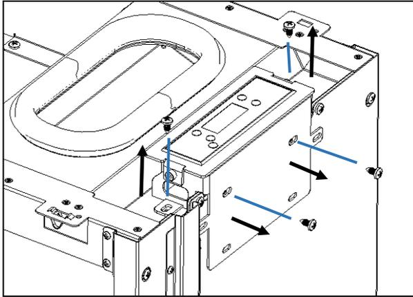
**Figura 50 - Remoção do display no equipamento**
