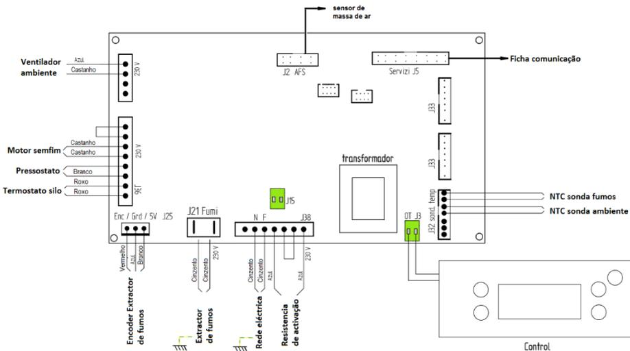
**Figura 153 – Esquema elétrico Salamandras K300 e K400**
