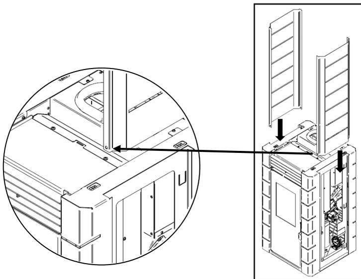
**Figura 27 - Colocação envoltórios laterais**
