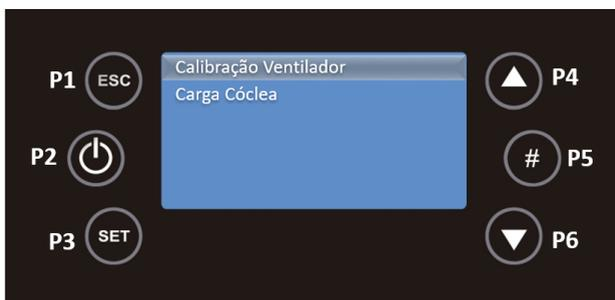
Neste submenu com as teclas P4 e P6 pode ajustar a velocidade do ventilador, entre -7 (-21%) e 7 (+21%). Para voltar ao menu Service pressione P1.
