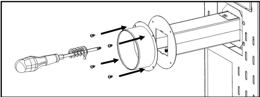
**Figura 116 – Fixação boca saída de ar na salamandra**
