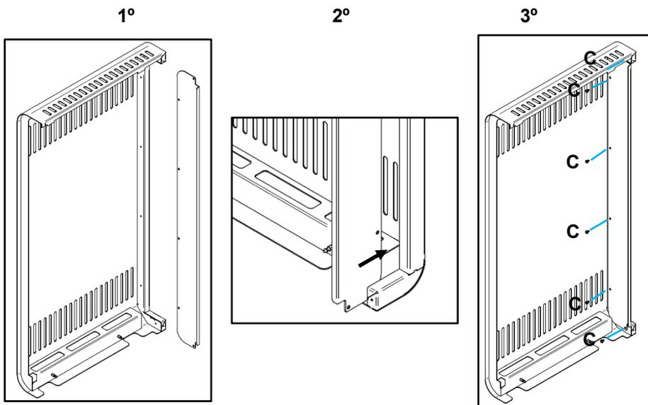
Figura 44 – União da envolvente com o remate frontal
