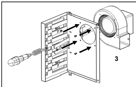
**Figura 111 – Fixação apoio com o ventilador**
