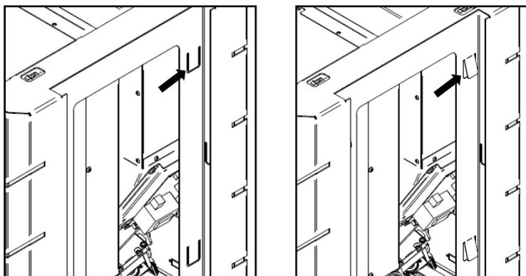
**Figura 28 - Apoios da cerâmica e vidro**
