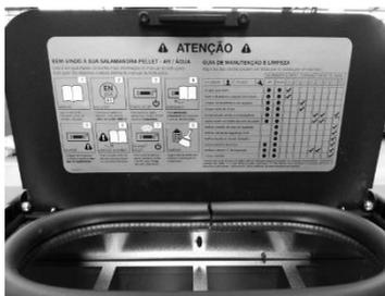
**Figura 136 – Etiqueta com as tarefas de manutenção**
