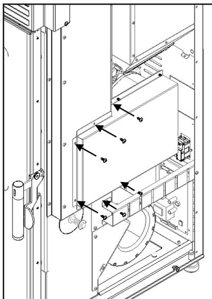
**Figura 128 - Fixação do ventilador na salamandra**
