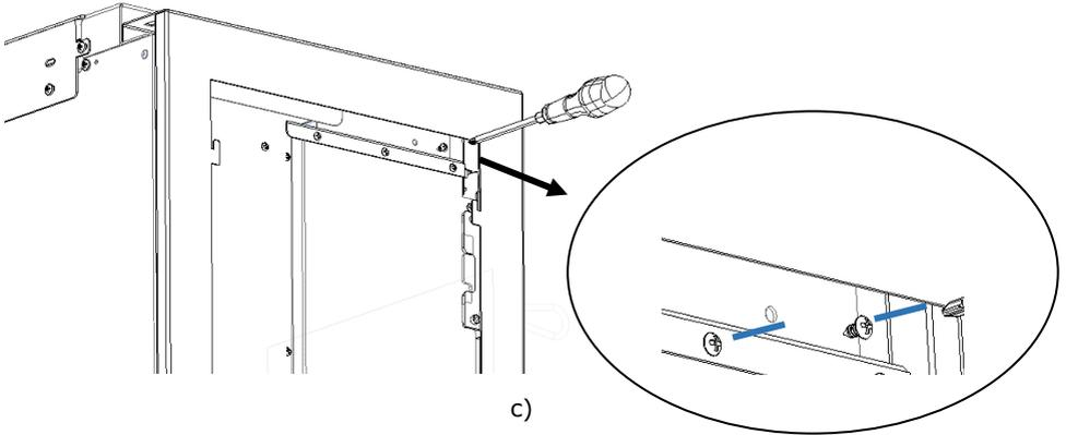
**Figura 64 C - Fixação das laterais estruturais Alpes K300**
