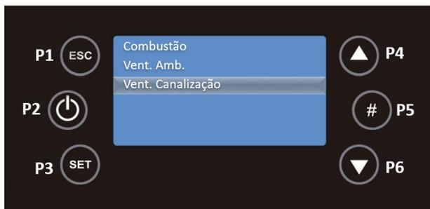
Este submenu permite modificar o valor de potência do ventilador de canalização. É apresentado apenas se selecionar um sistema de aquecimento que inclui um segundo ventilador de aquecimento. Com as teclas P4 e P6 pode ser definido na modalidade automática ou manual: no segundo caso, o utilizador seleciona a potência de 0 a 5.
