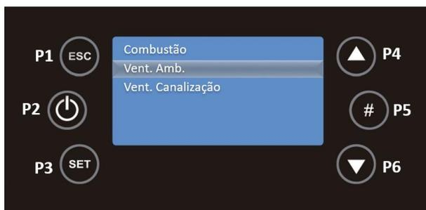
Com as teclas P4 e P6 pode modificar a potência de combustão do sistema. Este submenu permite modificar a potência de ventilação do sistema. Pode ser definido na modalidade automática ou manual: no segundo caso, o utilizador selecciona a potência de 0 a 5.
