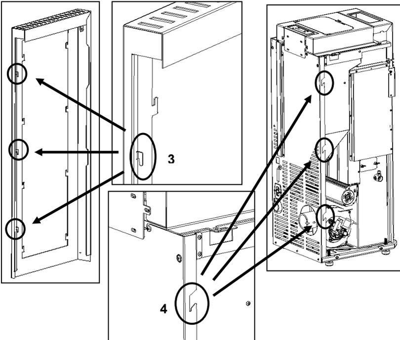
**Figura 65 - Encaixe lateral das estruturas laterais**
