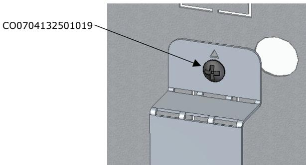
**Figura 17 – Marca triangular do módulo voltada para cima**
