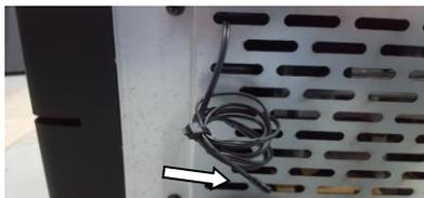
**Figura 9 – sonda de temperatura ambiente**
