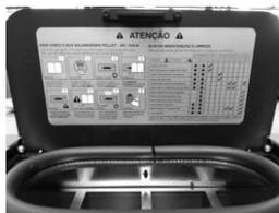
**Figura 18 – Etiqueta com as tarefas de manutenção**
