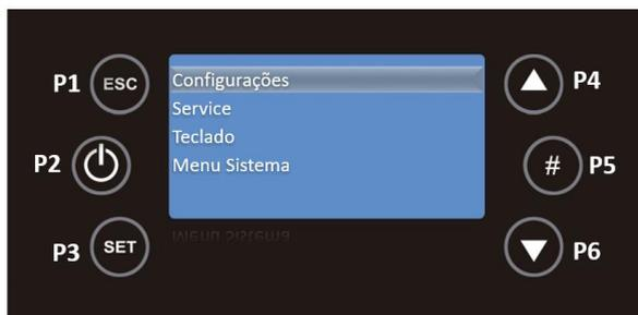
Com a tecla P6 seleccione o submenu Controle Remoto e para validar a entrada neste submenu a tecla P3.
