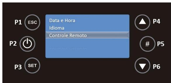
Com as teclas P4 e P6 pode ativar ou desativar o Comando Remoto, pressionando P3 para validar a ação.
