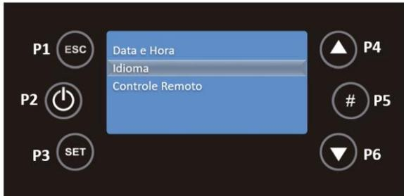
Dentro deste submenu, com P4 e P6 selecionar o idioma pretendido e voltar a pressionar a tecla P3 para validar.
