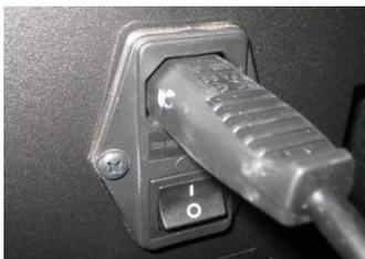
Figura 32 - Ficha de ligação corrente elétrica.
